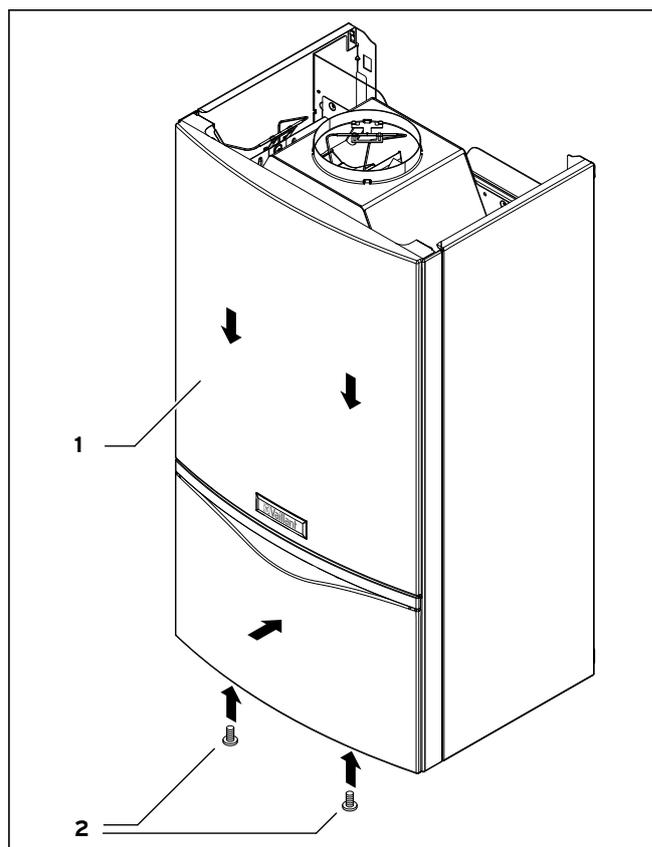
Рис. 4.9 Монтаж обшивки прибора (здесь изображен: atmoTEC plus)
