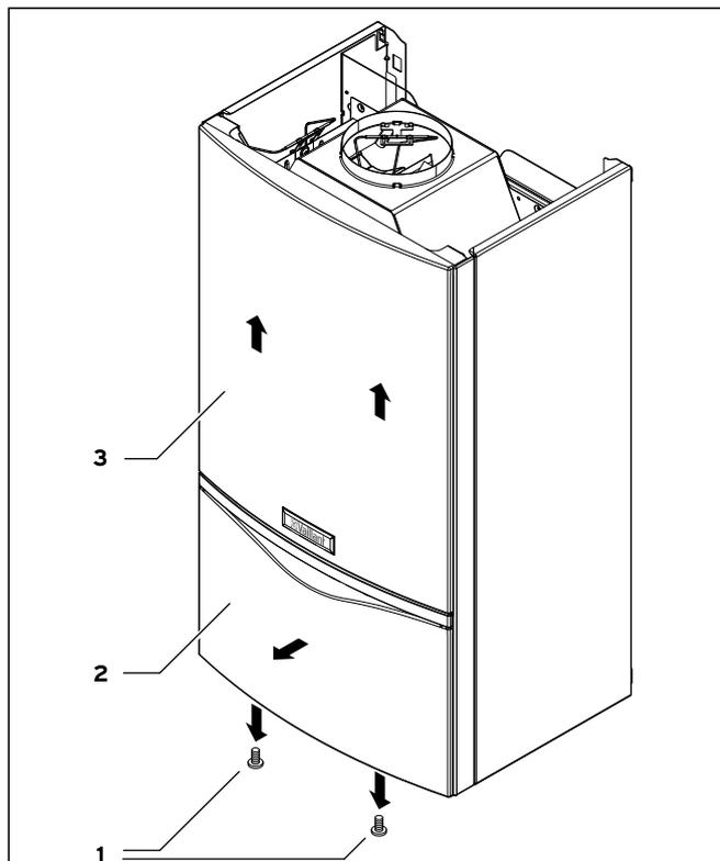
Мал. 4.6 Демонтаж передньої частини обшивання приладу
