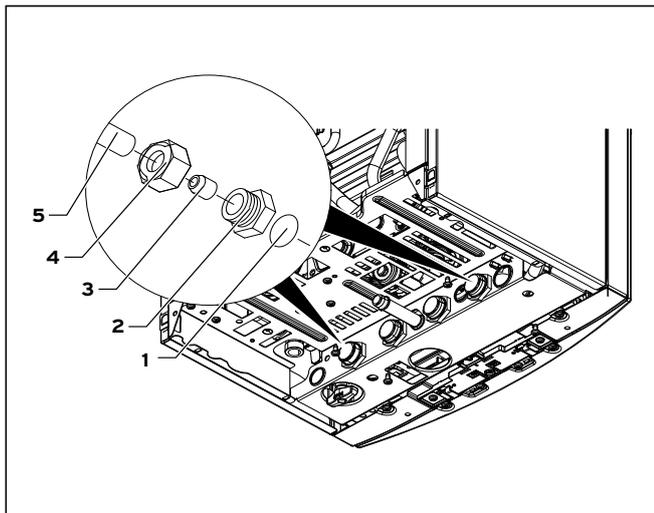
Рис. 5.3 Монтаж подающей и отводящей линий отопления (пример)
