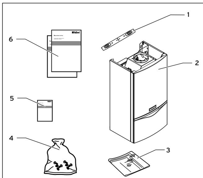
Рис. 4.1 Объем поставки (здесь изображен: atmoTEC plus)
