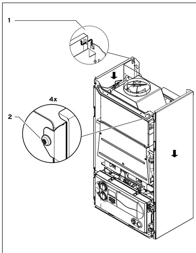
Рис. 4.8 Монтаж боковой обшивки
