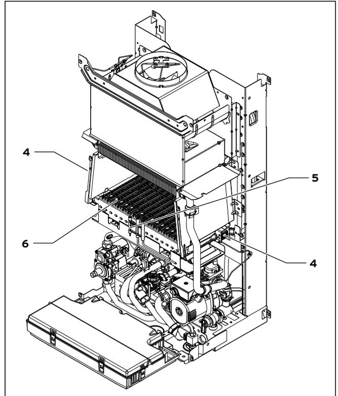
Рис. 8.3 Очистка горелки с демонтажем (более значительное загрязнение)
