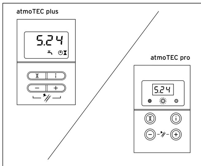
Рис. 6.9 Индикация на дисплее в режиме накопителя
