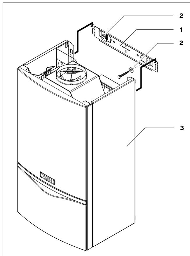
Рис. 4.5 Навешивание прибора (здесь изображен: atmoTEC plus)
