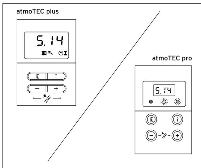
Рис. 6.8 Индикация на дисплее при подогреве воды
