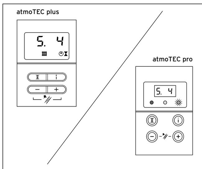
Рис. 6.7 Индикация на дисплее в режиме отопления
