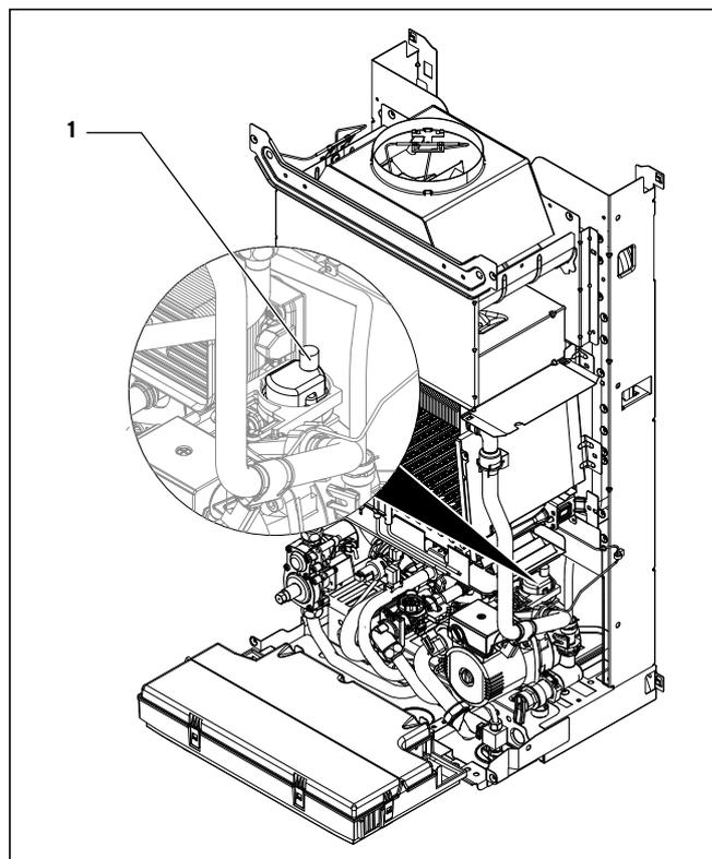
**Рис. 6.1 Быстродействующий воздухоотводчик**
