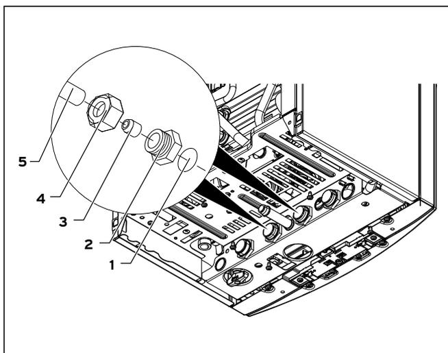
Рис. 5.2 Монтаж патрубков холодной и горячей воды (пример)
