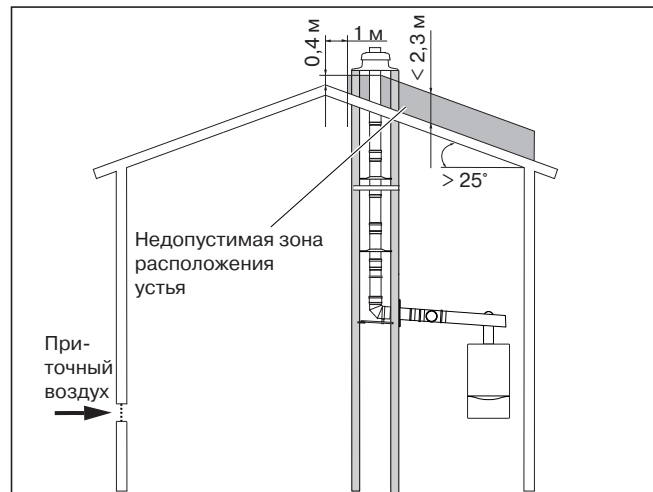
Рис. 2.2 Недопустимая зона расположения устья при наклоне крыши > 25^\circ , но только в том случае, если отверстия для притока воздуха и шахта расположены на противоположных сторонах конька крыши
